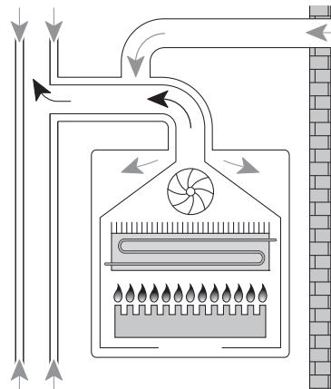
Vzduch možno takisto odoberať z voľného priestoru (príp. priestoru značne vzduchom zásobovaným) a spaliny odvádzať do spoločného komína (príp. opäť do priestoru so spoločným výskytom spalín). Sem patrí aj zvláštny prípad B<sub>22</sub> - pozri ďalší text.
