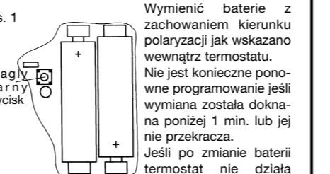
Wymienić baterie z zachowaniem kierunku polaryzacji jak wskazano wewnętrz termostatu.
