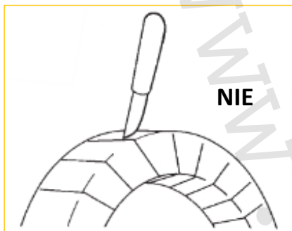
Obr. 5 – Nepovolený spôsob pri odstraňovaní obalu
