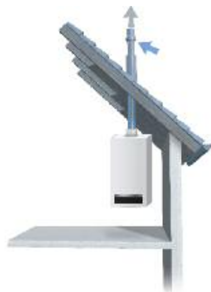
Variant inštalácie pre prevádzku nezávislú od vzduchu v miestnosti s odvodom spalín nad strechu
