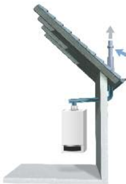
Variant inštalácie pre prevádzku nezávislú od vzduchu v miestnosti so systémom odvádzania spalín cez plastovú koncentrickú rúru (vonkajšia fasáda)
