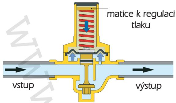
**Provoz tlakového redukčního ventilu je založen na vyrovnání dvou protilehlých sil:**
