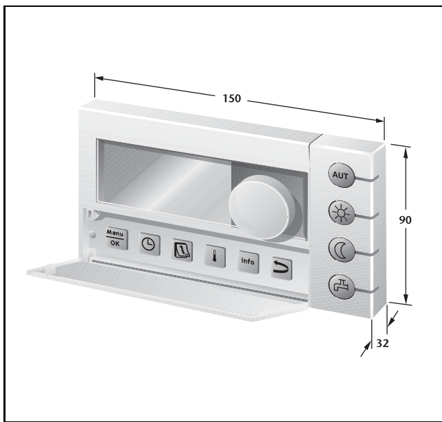
Obr. 75 Rozmery ovládacej jednotky RC35 (rozmery v mm)
