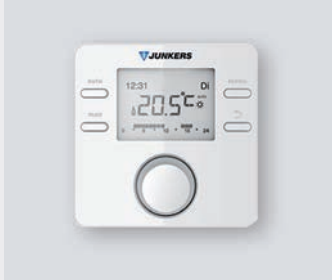
CR 100 Regulátor s týdenním programem řízený podle prostorové teploty pro jeden míchaný nebo nemíchaný vytápěcí obvod s přípravou teplé vody a volitelně se základním solárním systémem. Může sloužit i jako dálkové ovládání pro regulátor CW 400 nebo také pro zónovou regulaci v kombinaci s modulem MZ 100 (max. 3 x CR 100 pro jeden modul). Týdenní program pro vytápění se 6 spínacími body během dne. Dvě nastavitelné úrovně teploty. Kompatibilní s modulem MM 100 a MS 100.
