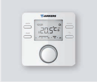
CW 100 Ekvitermický regulátor s týdenním programem řízený podle venkovní teploty pro jeden míchaný nebo nemíchaný vytápěcí obvod s přípravou teplé vody a volitelně se základním solárním systémem. Může sloužit i jako dálkové ovládání pro regulátor CW 400. Týdenní program pro vytápění se 6 spínacími body během dne. Dvě nastavitelné úrovně teploty. Kompatibilní s modulem MM 100 a MS 100.
