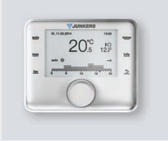
CW 400 Systémový regulátor řízený podle venkovní teploty pro plynové kotle do 4 vytápěcích obvodů bez dálkového ovládání a 2 nabíjecí obvody TUV, pro jednoduché/komplexní vytápěcí systémy. Týdenní program pro vytápění se 6 spínacími body během dne. Dvě nastavitelné úrovně teploty. Kompatibilní s modulem MM 100 a MS 100/200, MC 400. 2 obvody teplé vody, solární ohřev teplé vody, solární podpora vytápění. Možnost výběru dvou volně nastavitelných týdenních programů pro vytápěcí obvod. Program pro cirkulační čerpadlo, dovolenkový program.
