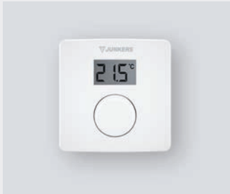
CR 10 Jednoduchý prostorový regulátor pro jeden nemíchaný vytápěcí obvod. Může sloužit i jako dálkové ovládání pro regulátor CW 400 nebo také pro zónovou regulaci v kombinaci s modulem MZ 100 (max. 3 x CR 10 pro jeden modul). Displej zobrazuje prostorovou teplotu, případně kód poruchy.
