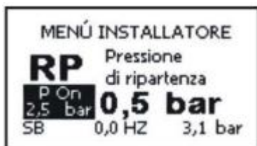
Obrázek 13: Nastavení tlaku pro restart čerpadla
