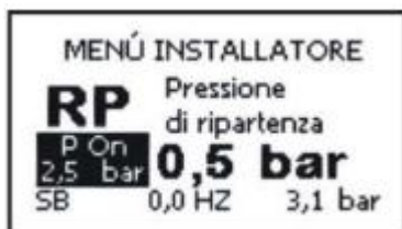
Obrázek 13: Nastavení tlaku pro restart čerpadla
