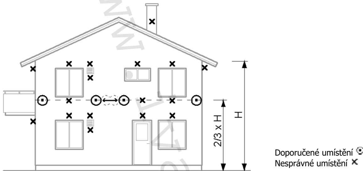
Venkovní snímač je připojen dvoužilovým kabelem. Max. délka kabelu 50 m platí pro průřez  $0,75 \text{ mm}^2$ . Pro větší délky až do max. 120 m se používá průřez  $1,5 \text{ mm}^2$ .
