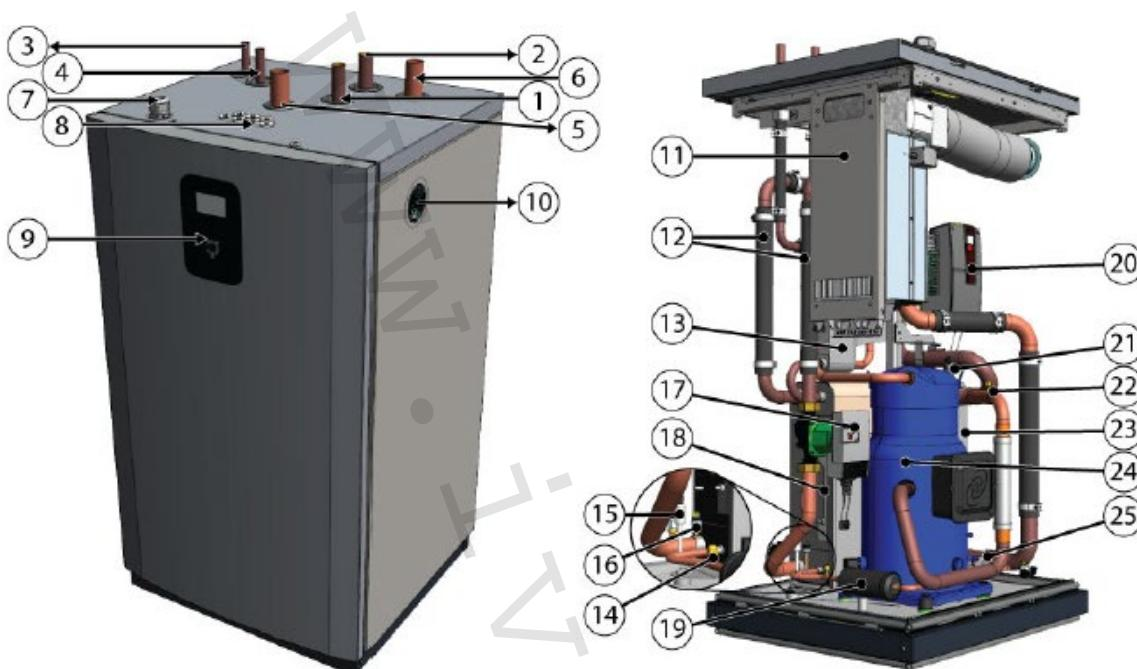
Šípky označují vstupy a výstupy tepelného čerpadla.
