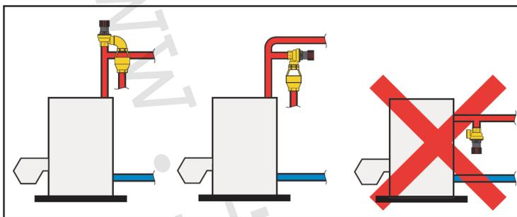
Nutno dodržet směr proudění vyznačený na těle pojistného ventilu šipkou. Pojistné ventily musí být instalovány v horní části tepelného zdroje nebo na přívodním potrubí, ve vzdálenosti ne větší než 1 m od tepelného zdroje. Potrubí spojující pojistný ventil s tepelným zdrojem nesmí být odpojitelné a uzavíratelné.
